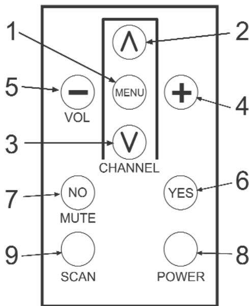
1) Tasto Menù, permette di attivare e disattivare il menù "On Screen", le funzioni del menù di regolazione sono:
